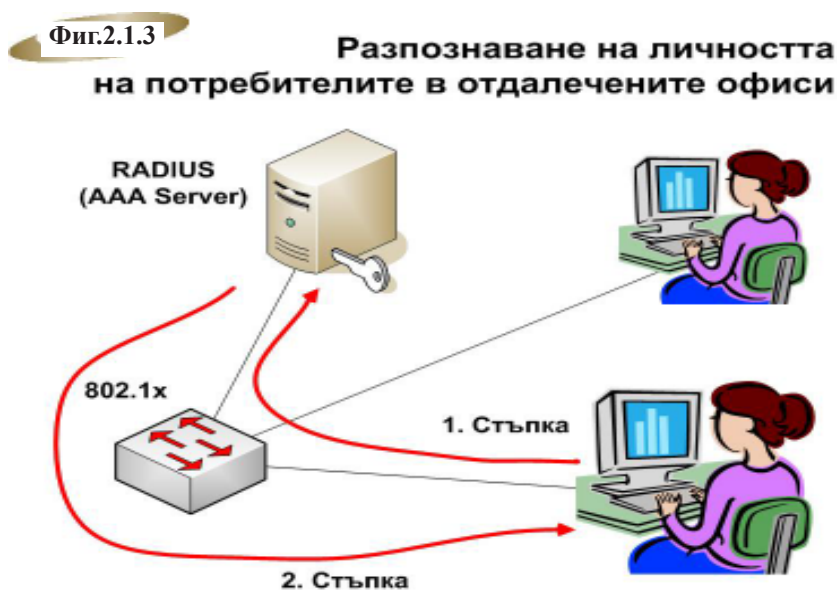
Фиг. 2.1.3. Принципната схема на легитимиране на потребителя
